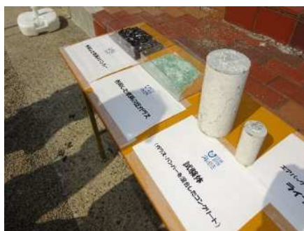
材料で自動車廃材のガラス、バンパーが活用されています
