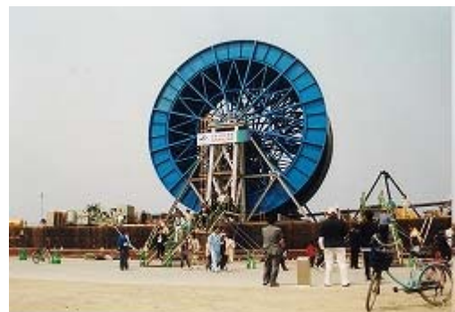
取水管（硬質ポリエチレン管）の巻いてあるドラムはなんと直径19m!!!
